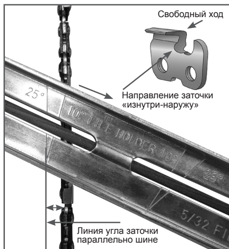
Рис. 22 Расположение линии угла заточки
