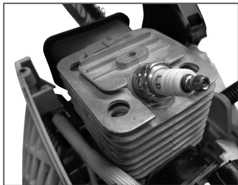
Рис. 28 Охлаждающие ребра цилиндра
