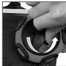
Рис.4 Снятие крышки шины
