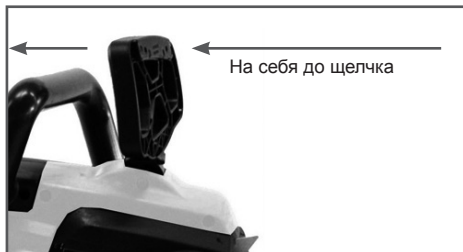
Рис.3 Отключение ручки тормоза
