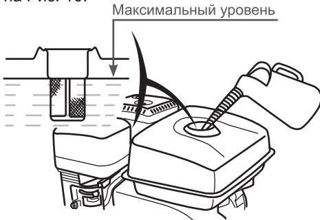
Рис. 10 Максимальный уровень топлива в топливном баке
